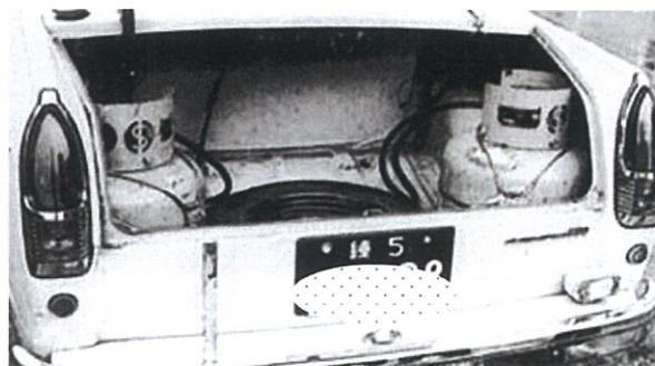
写真 1 当時トランクに搭載した 10kg 脱着容器
